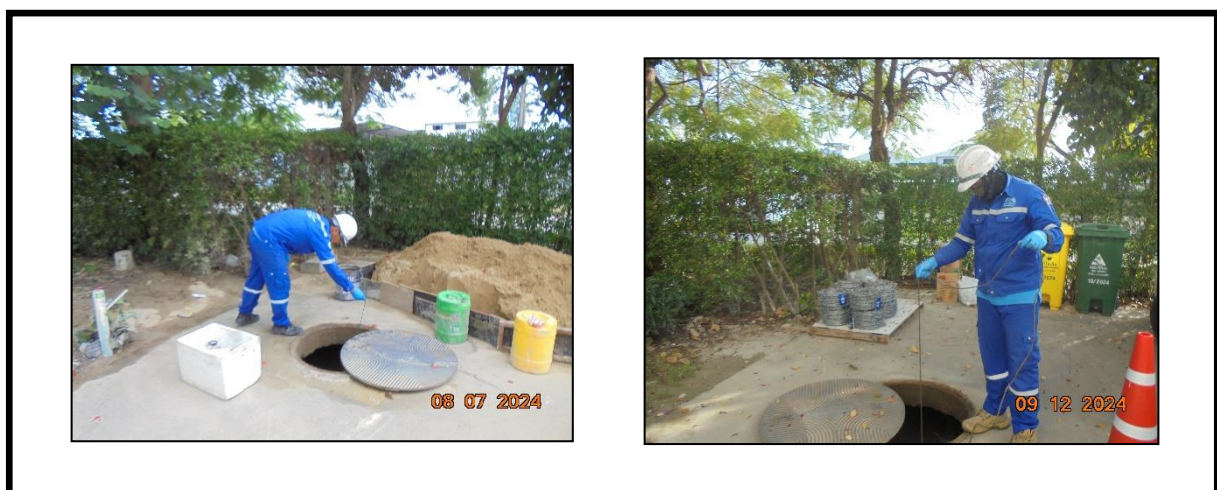
รูปที่ 3.2-5 จุดตรวจวัดคุณภาพน้ำทิ้ง ป่อตรวจคุณภาพน้ำก่อนระบายลงสู่ท่อระบายน้ำ ริมถนนซอยจรรยาบรรณ 6
